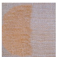
Mostra d'assaig després de la neteja amb detergent EMPA s/n ISO 105-C06/97
